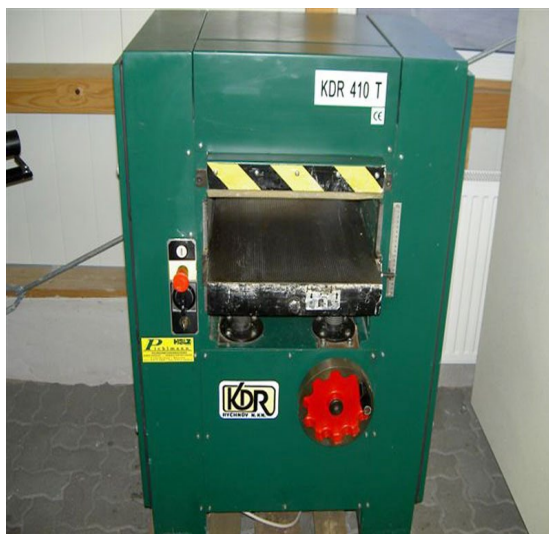
Слика 1. Дебљача опремљена заштитником у облику поклопца
