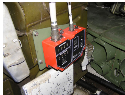
Слика 3. Унутрашњост основног тенка М-84А, компоненте противпожарног система обојене у црвену боју
