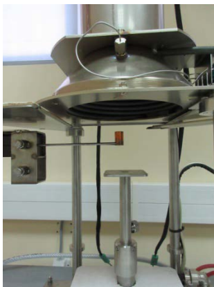
Слика 4 – Калибрација калориметра: а) калибрација грејача, б) калибрација термопарова
