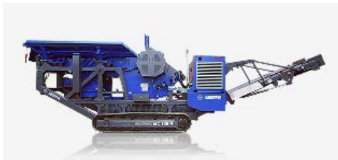
Слика 4 – Мобилно постројење фирме "Kleemann" капацитета 200t/h [17]
