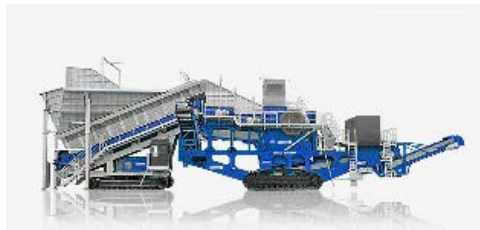
Слика 5 – Мобилно постројење фирме "Kleemann" капацитета 1500t/h [17]
