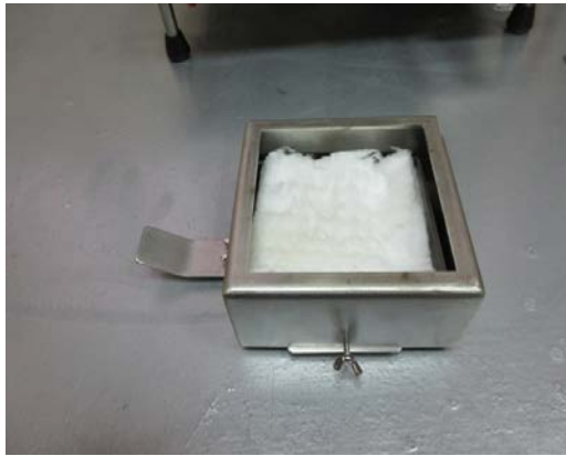
Слика 5 – Држац узорка са керамичким влакнастим изолационим материјалом
