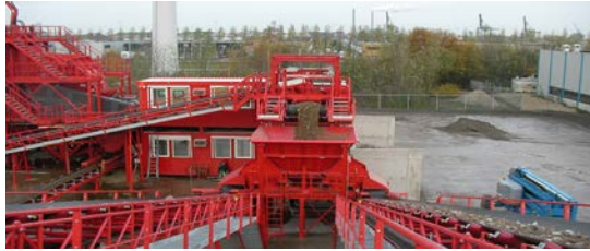
Слика 6 – Дио стационарног постројења за рециклажу – фаза дробљења [17]
