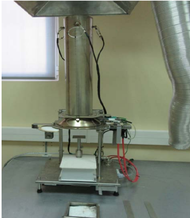
Слика 3 – Изглед калориметра у Лабораторији за заштиту од пожара Факултета заштите на раду у Нишу
