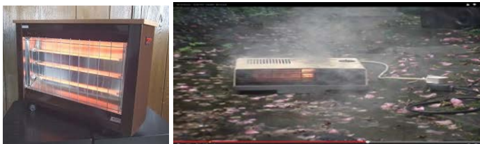
Слика 5 – Грејалице као узрок пожара
