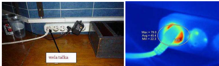
Слика 7 – Фотографска и термографска слика лошег споја утикача и утичнице у продужном каблу
