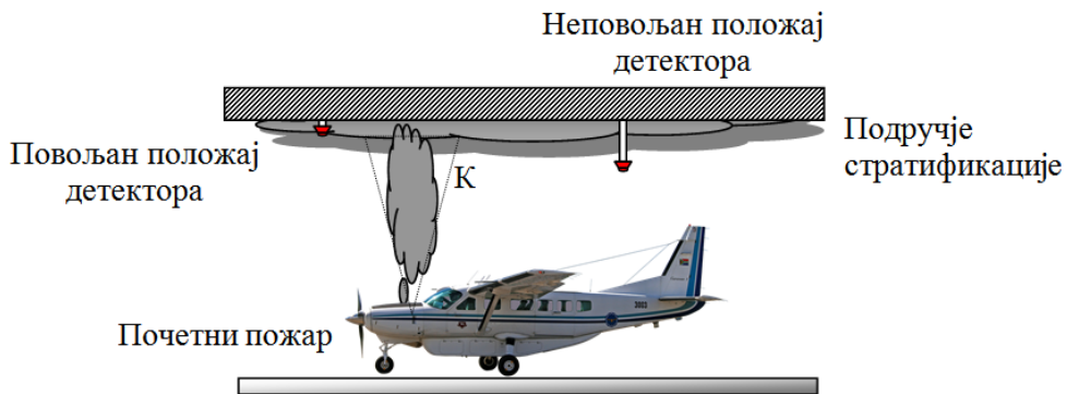
Слика 1 – Положај детектора у хангару са равним кровом
