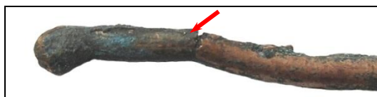
б) Незавершенная фрагментация. Трещина в однопроволочном проводнике
