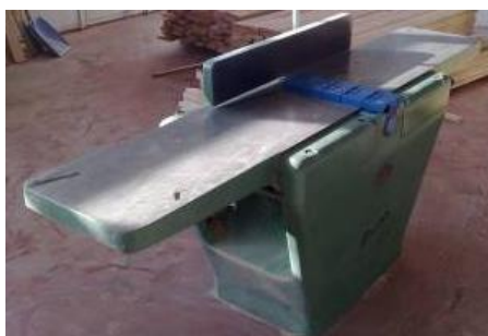
Слика 6 Заштитник од малих пластичних међусобно повезаних елемената
