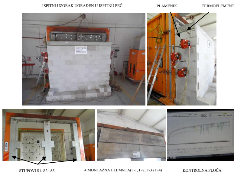
Slika 4 Detalji ugradnje uzorka u ispitnu požarnu peć i prikaz kontrolne ploče tijekom ispitivanja
