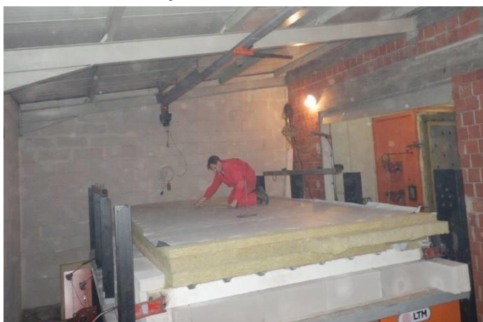
Slika 7 Ispitivanje sistema slaganog krova „požar iznutra“ - horizontalna ispitna peć[4]
