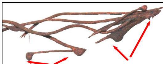
в) Фрагментированные и оплавленные с двух концов жилы
