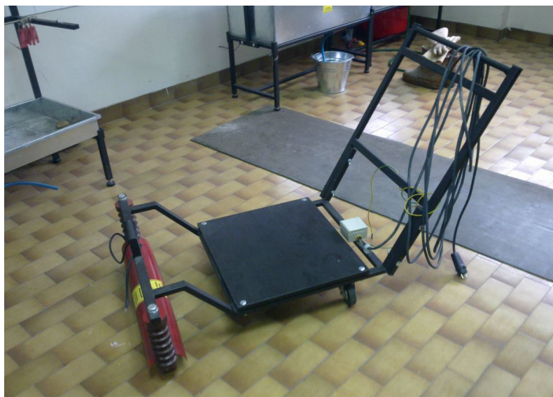
Слика 6. Колица за испитивање електроизолационих простирки у електроенергетским постројењима
