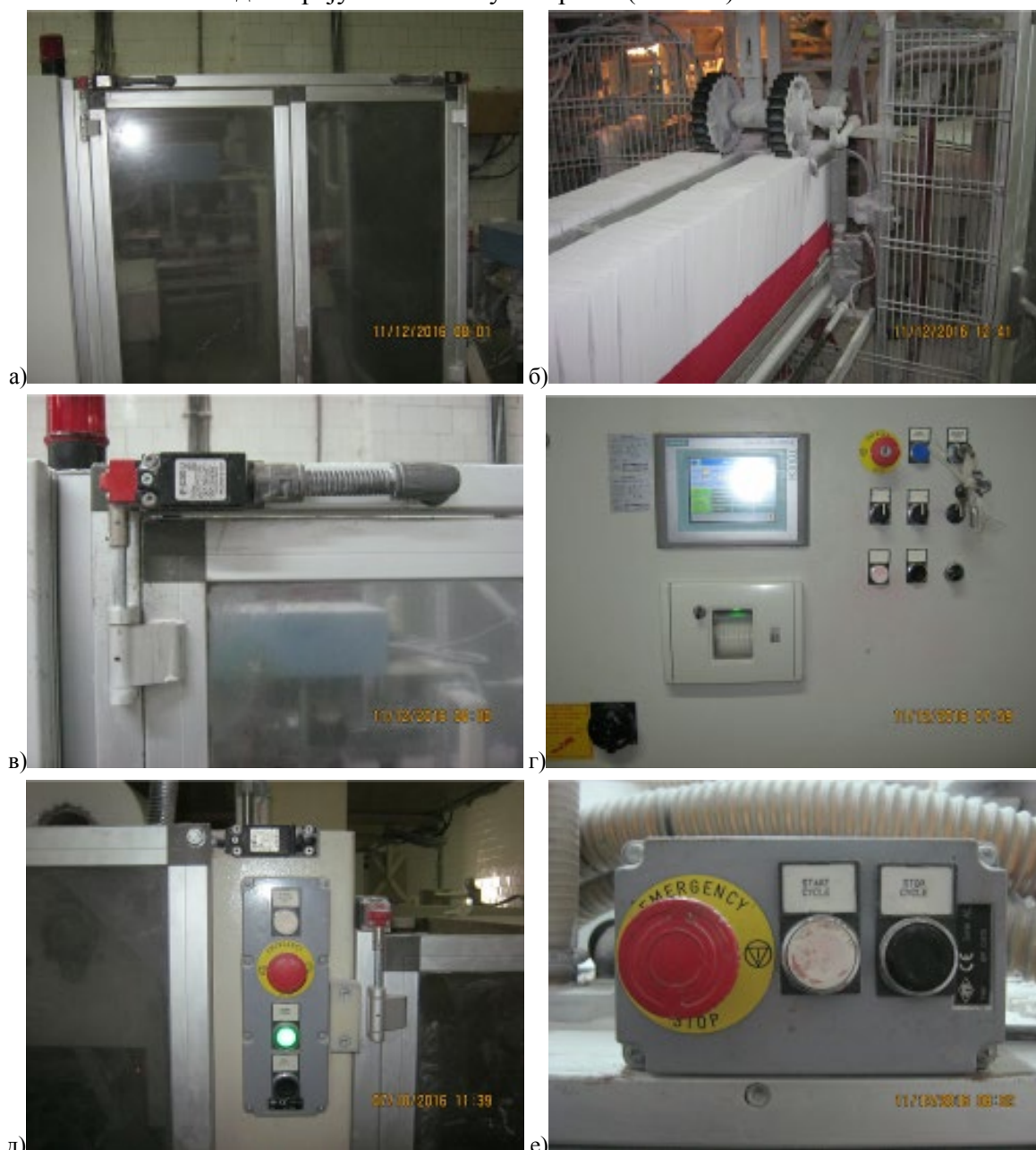
Слика 4. Безбедносни елементи на аутоматској линији: а) заштитне врата, б) приказ заштитног прекидача, в) заштитна мрежа испред магацина за кесе, г) СТОП прекидач нужног искључења на управљачком орману, д) СТОП прекидач нужног искључења на машини за збирно паковање, е) СТОП прекидач нужног искључења на аутоматској пакерици са прекидачима за кретање и заустављање линије
