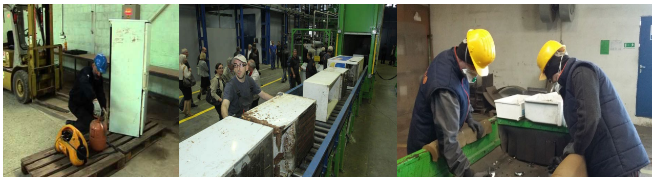
Слика 2. Демонтажа и рециклажа отпадних расхладних уређаја
