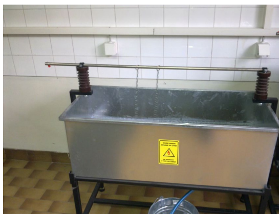
Слика 5. Изглед електроизолационе чизме и кадице KIEO за њихово испитивање
