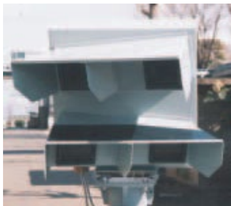
Слика 6. Систем са две стерео камере [17]
