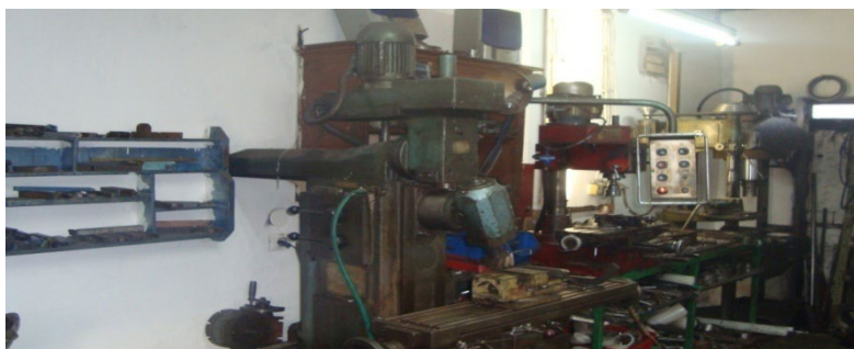
Слика 2. Изглед машина у радионици са леве стране (универзална глодалица, преса и стубна бушилица)[7]
