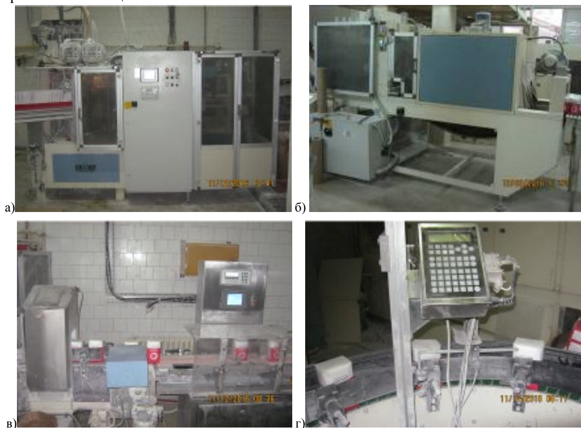
Слика 1. Аутоматска линија за паковање шећера: а) аутоматска пакерица, б) аутоматска машина са термо тунелом за збирно паковање, в) део транспортне везе са детектором метала и контролном вагом, г) део транспортне везе са ink jet датумаром
