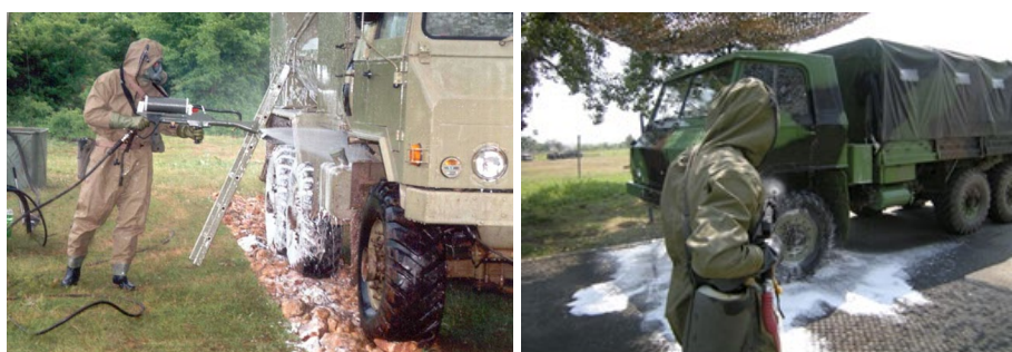
Слика 4. Хемијска деконтаминација покретних средстава
