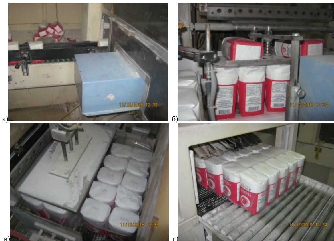
Слика 3. Аутоматска машина са термо тунелом за збирно паковање:
