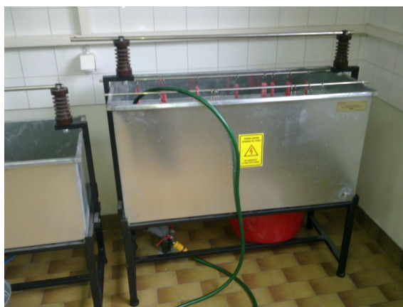
Слика 4. Изглед електроизолационих рукавица и кадице KIER за њихово испитивање
