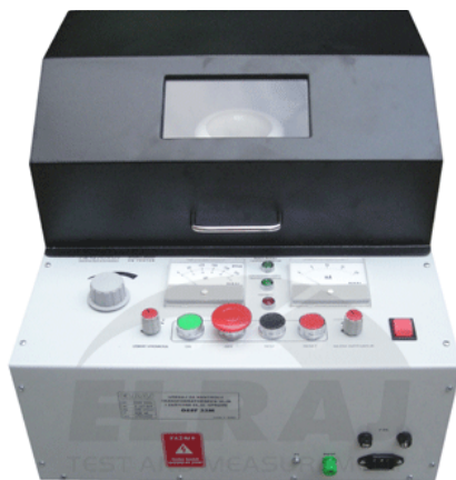
Слика 1. Уређај за испитивање трафо уља и заштитне електроизолационе опреме OEST 35M
