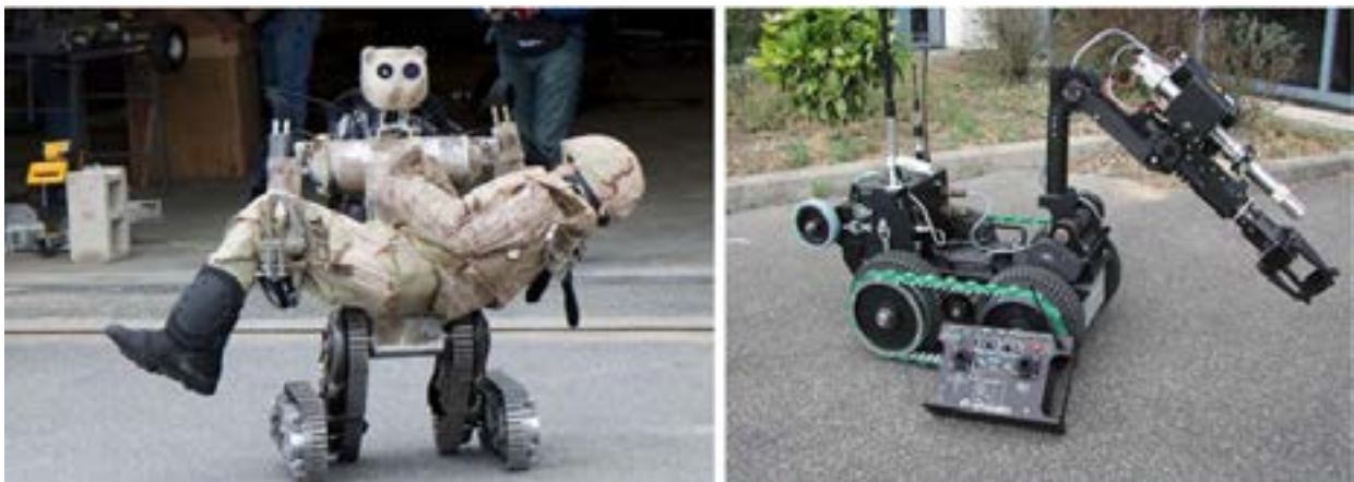
Слика 11. RoboCue – робот за тражење и спасавање унесрећених у земљотресима [10]
