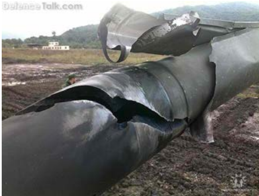
Слика 3 – Оштећена цев топа 125mm услед превремене експлозије пројектила
