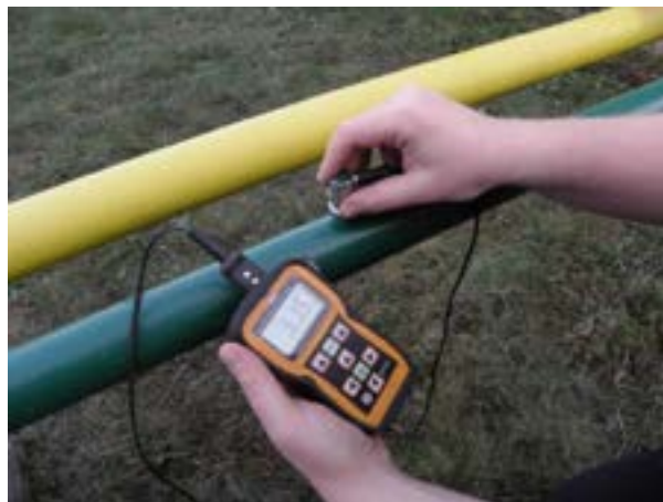
Slika 6. Ultrazvučno mjerenje debljine stjenke
