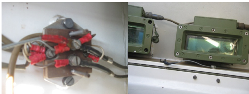
Слика 4а - Повезивање „+“ пола Слика 4б - Повезивање „-“ пола
