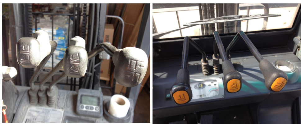
Слика 2 – Симболи за означавање управљачких уређаја код виљушкарца
