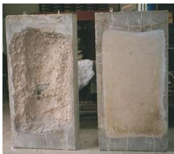
Slika 11. Izgled bloka od običnog betona (levo – eksplozivni spaling) i mikroarmiranog betona sa PP vlaknima (desno) nakon izlaganja požarnim temperaturama
