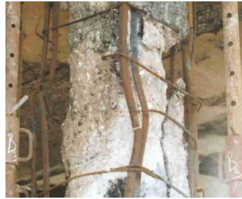
Figure 8. Plastične daformacije i pucanje šipki armature
