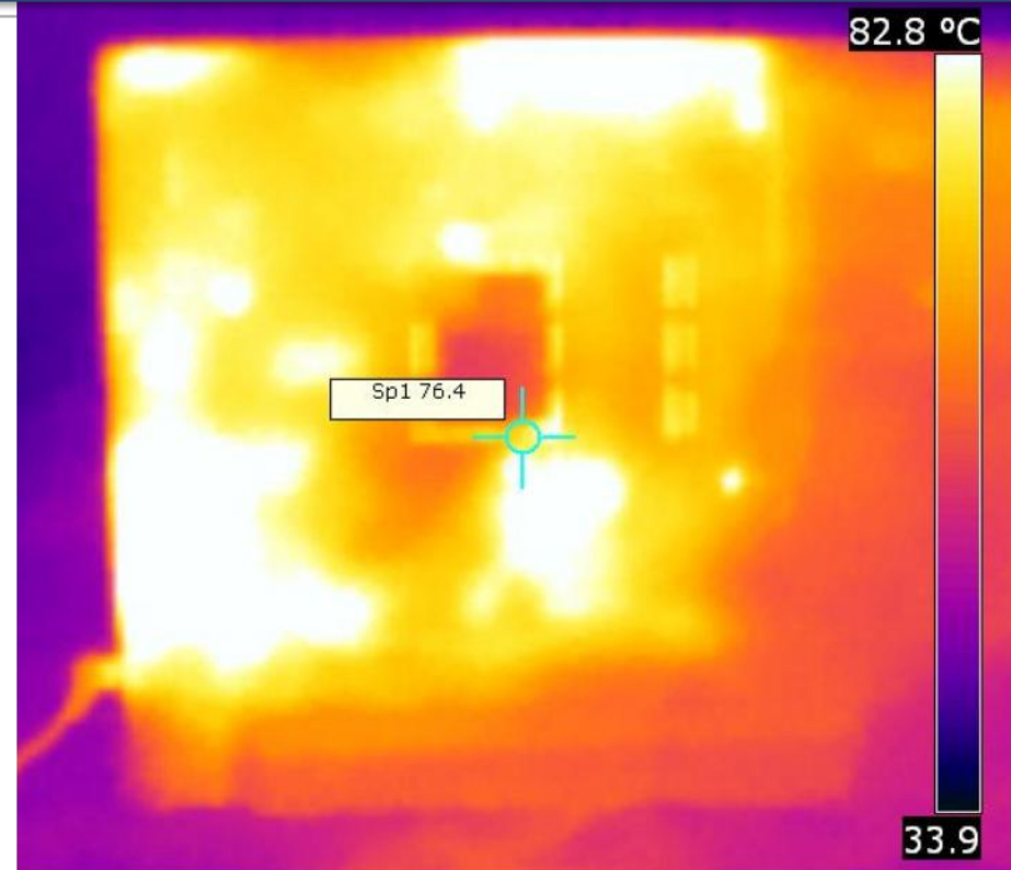
Слика 8: Лап топ у раду на подлози која затвара вентилационе изводе и температурна слика електронских компоненти при таквом раду
