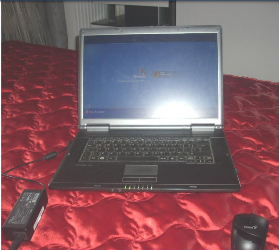
Слика 8: Лап топ у раду на подлози која затвара вентилационе изводе и температурна слика електронских компоненти при таквом раду
