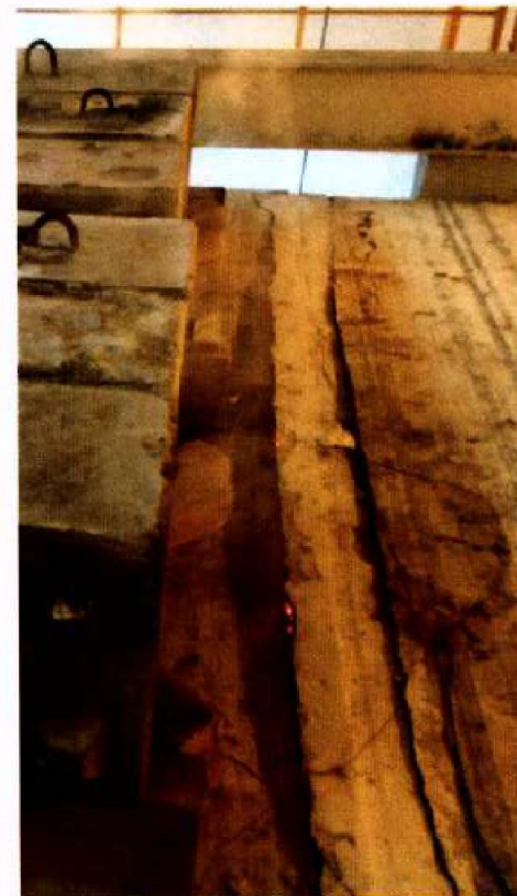
92 minuta – znatno vidljiva deformacija i pukotine na uzorku
